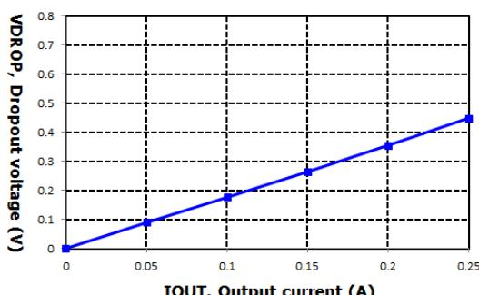
VIN=4.0V, VOUT=3.0V @ IOUT=250mA per 50mA step
