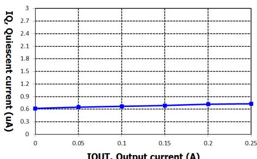
VIN=4.0V, VOUT=3.0V @ IOUT=250mA per 50mA step
