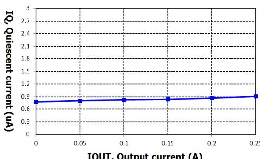
VIN=4.3V, VOUT=3.3V @ IOUT=250mA per 50mA step
