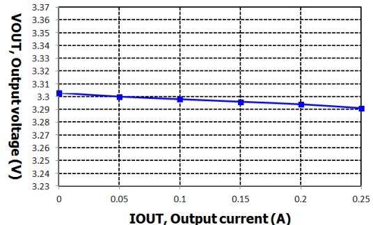
VIN=4.3V, VOUT=3.3V @ IOUT=250mA per 50mA step
