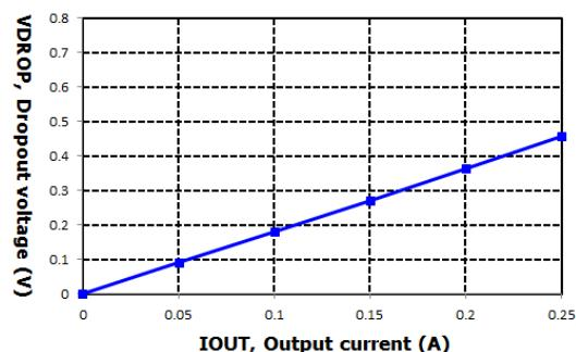
VIN=4.3V, VOUT=3.3V @ IOUT=250mA per 50mA step
