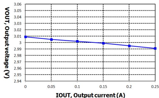
VIN=4.0V, VOUT=3.0V @ IOUT=250mA per 50mA step
